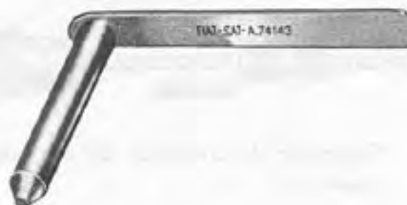
A. 74143 Cheville de guidage pour mise en place des cales d'épaisseur sur le bras oscillant de suspension AR.
