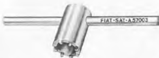
A. 57003 Clé de virole de butée de vis sans fin.
