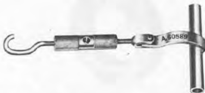
A. 60589 Etrier de soutien du moteur sur voiture lors de la dépose/repose de la traverse arrière.
