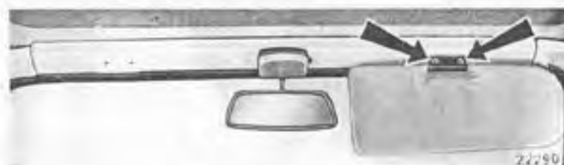
Dépose des pare-soleil.
