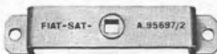
A. 95697/2 Pièce à utiliser avec le dynamomètre A. 95697 pour contrôler le couple de rotation des roues arrière.
