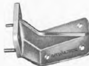
A. 74032 Support pour la révision du boîtier de direction (à utiliser si le support A. 74076/1 n'est pas disponible).
