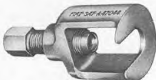
A. 47044 Extracteur de rotules de barres de direction.
