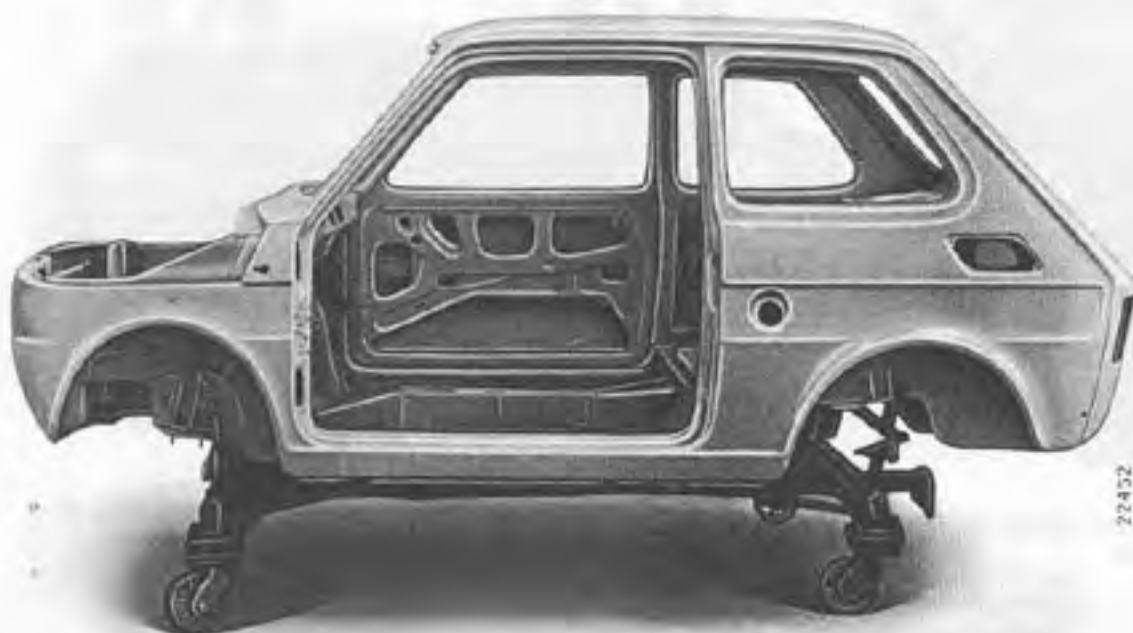
Vue de la caisse sur le chariot transporteur, sans capot de malle et porte gauche.
