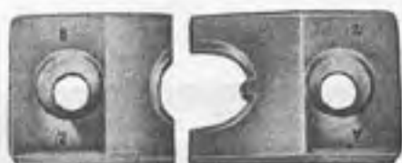
A. 74140/2 Paire d'embouts pour sertissage des écrous de moyeux de roues AV (à utiliser avec A. 74140/1 ).
