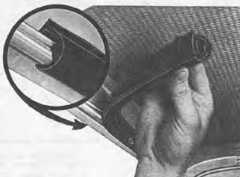
Montage du caoutchouc sur la gouttière de la lunette.
