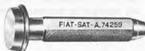
A. 74259 Chasse pour monter la bague extérieure du roulement intérieur des moyeux de roues AV.
