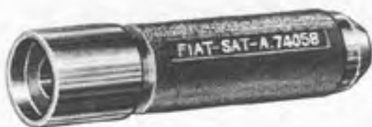
A. 74058 Chasse pour monter les bagues élastiques sur le bras oscillant de suspension AV.
