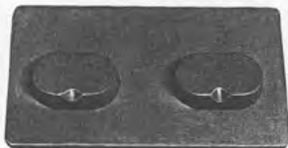
A. 60158 Base d'appui de la culasse pendant la dépose et la pose des soupapes.
