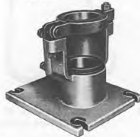
A. 60027 Outil avec bague A. 60027/19 de fixation des cylindres pour le réalésage.
