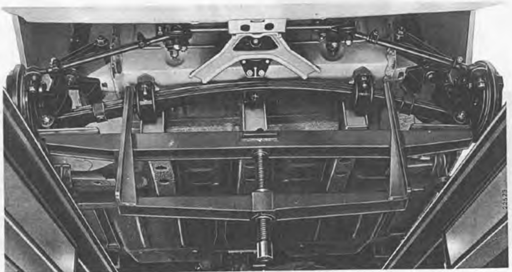
Montage du ressort à lames sous la caisse, à l'aide de l'outil A. 74061.
