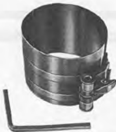
A. 60605 Collier pour introduire les pistons dans (*) les cylindres.
