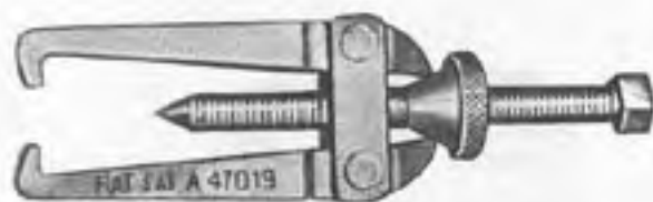
A. 47019 Extracteur de bague intérieure de roulements de vis sans fin.
