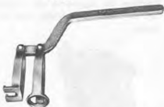
A. 60084 Outil pour la dépose et la pose des soupapes.
