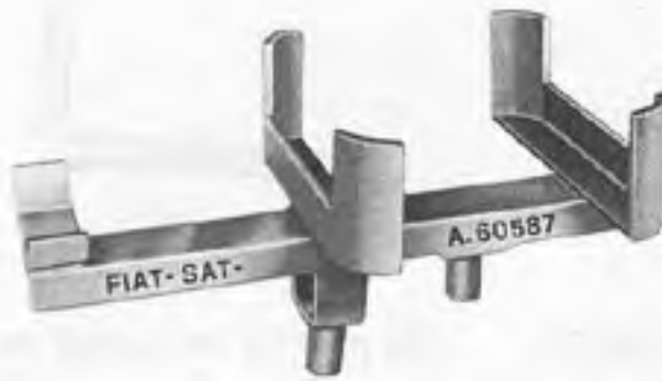
A. 60587 Support pour la dépose et la pose du moteur et du groupe motopropulseur.
