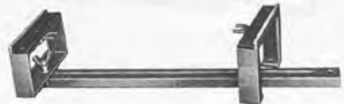
A. 60041 Outil pour y appuyer la culasse pendant la rectification des sièges de soupapes.
