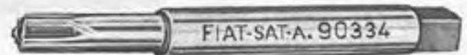
A. 90334 Alésoir de logements de pieds de centrage sur paliers de vilebrequin.
