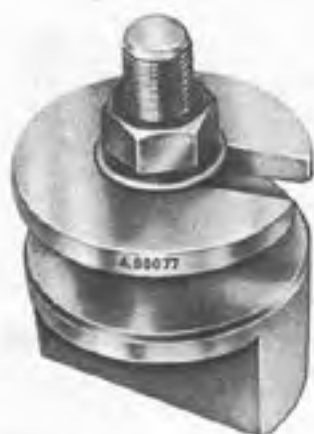
A. 60077 Outil de maintien de la bielle pendant le réalésage de la bague de pied de bielle.
