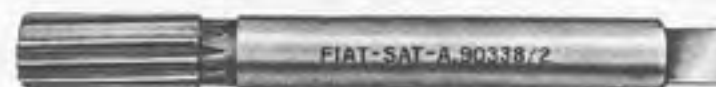
A. 90338/1 } Alésoirs de sièges de poussoirs cote A. 90338/2 } réparation (1re et 2e majoration).
