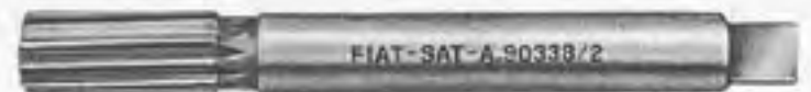
A. 90338/1 | Alésoirs de sièges de poussoirs cote A. 90338/2 | réparation (1re et 2e majoration).
