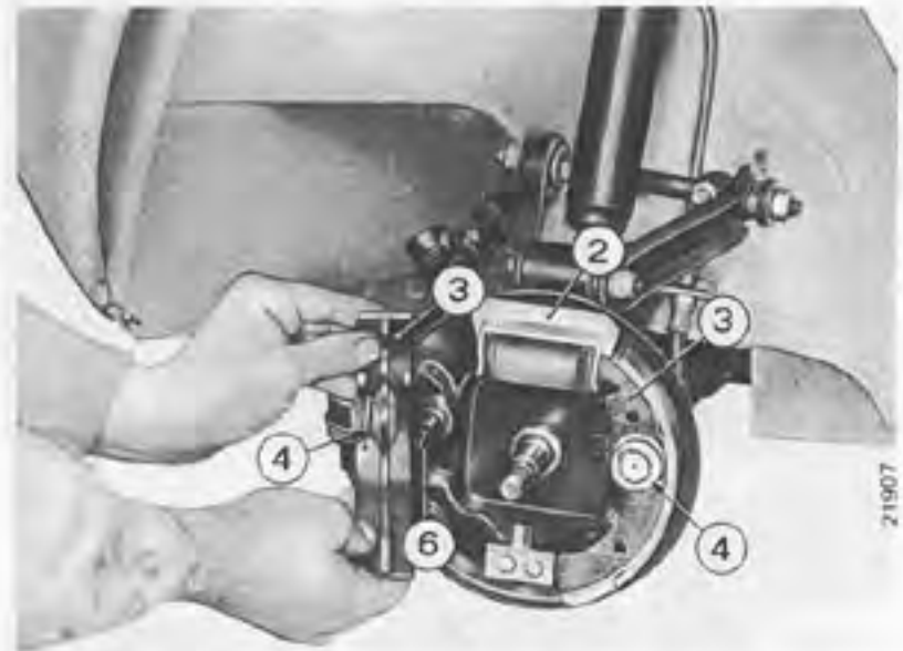
Dépose des mâchoires après application de l'outil A. 72235 de maintien des pistons dans le cylindre.
