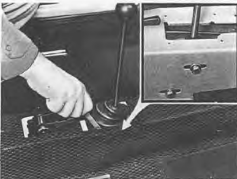
Blocage des vis de fixation de l'ensemble support de levier de commande des vitesses au tunnel après le réglage.
