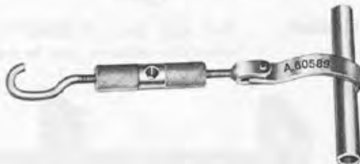
A. 60589 Etrier de soutien moteur sur voiture lors de la dépose/repose de la traverse arrière.
