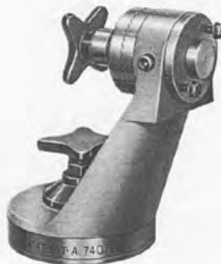
A. 74076/1 Support universel pour révision du boîtier de direction.
