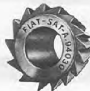
Fraise (75°) pour réduire la largeur des sièges de soupapes.
