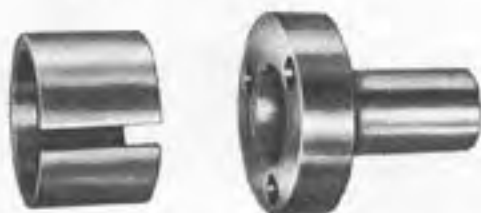
A. 60152 Flasque et bague de positionnement du vilebrequin sur la rectifieuse.
