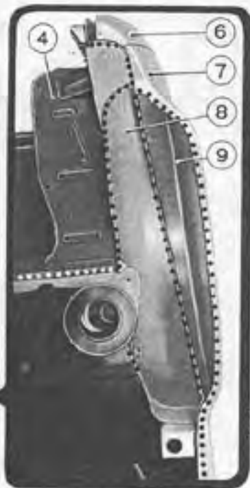
Indication des jonctions, par points de soudure, des tôles de protection du compartiment moteur et du passage de roue AR droit.
