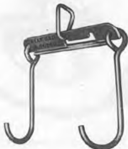
A. 60588 Palonnier de levage et déplacement moteur et groupe motopropulseur.
