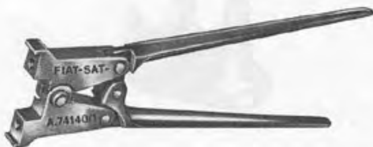
A. 74140/1 Pince de sertissage des écrous de moyeux de roues AV.
