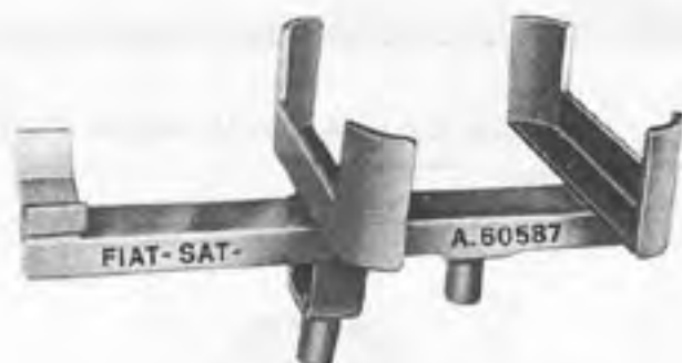
A. 60587 Support pour la dépose et la pose du moteur et du groupe motopropulseur.
