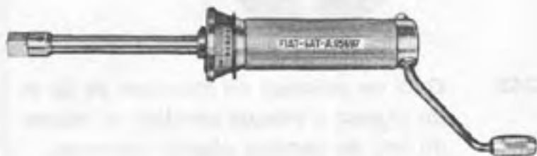
A. 95697 Dynamomètre pour le contrôle du couple de rotation des roulements des roues arrière.
