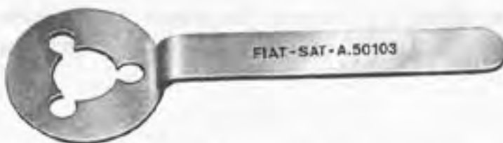
A. 50103 Clé de maintien de la poulie pendant la dépose et la pose de la dynamo et du ventilateur.
