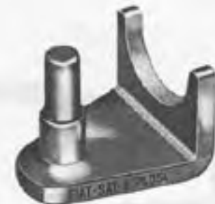
A. 74054 Outil pour immobiliser le demi-bras de suspension AV lors de dépose des bagues élastiques.
