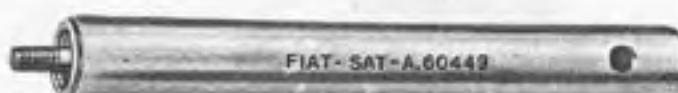
A. 60449 Paire de tiges filetées d'entraînement du volant pour le calage de la distribution.
