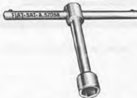
A. 57058 Clé pour bouchon de maintien du piston d'amortisseurs.
