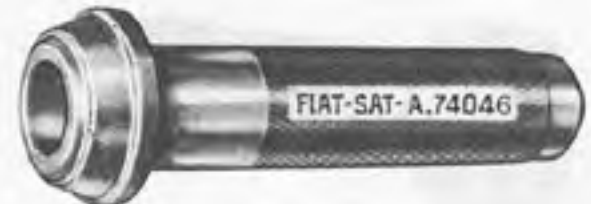
A. 74046 Chasse pour monter la bague extérieure du roulement extérieur de roues AV.
