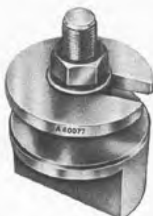
A. 60077 Outil de maintien de la bielle pendant le réalésage de la bague de pied de bielle.
