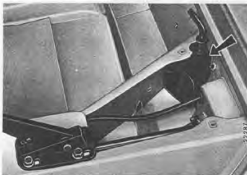
Vue du raccord avant d'amenée d'air chaud au convoyeur central.
