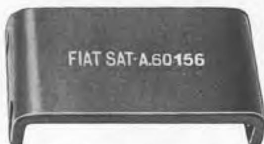
A. 60156 Outil pour fixer les cylindres lorsqu'on renverse le moteur pour le réviser.
