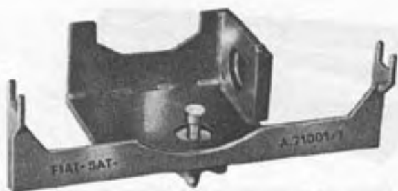
A. 71001/7 Support de l'ensemble boîte de vitesses-différentiel pendant la révision - à utiliser avec le chevalet pivotant Ar. 22204 .
