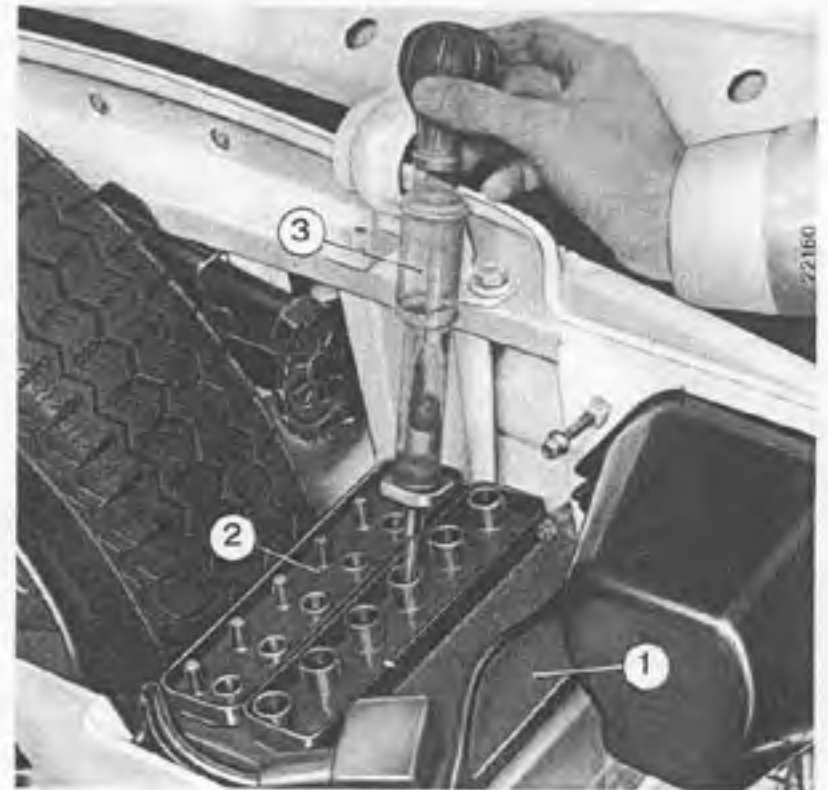
Mesure de l'état de charge de la batterie à l'aide du densimètre A. 95852.
