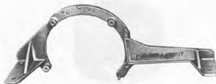
A. 61001/7 Etrier de fixation du moteur au chevalet pivotant Ar. 22204 .
