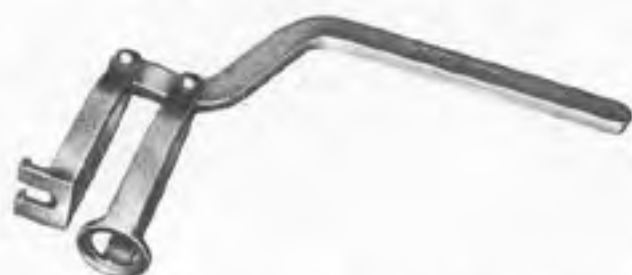
A. 60084 Outil pour la dépose et la pose des soupapes.
