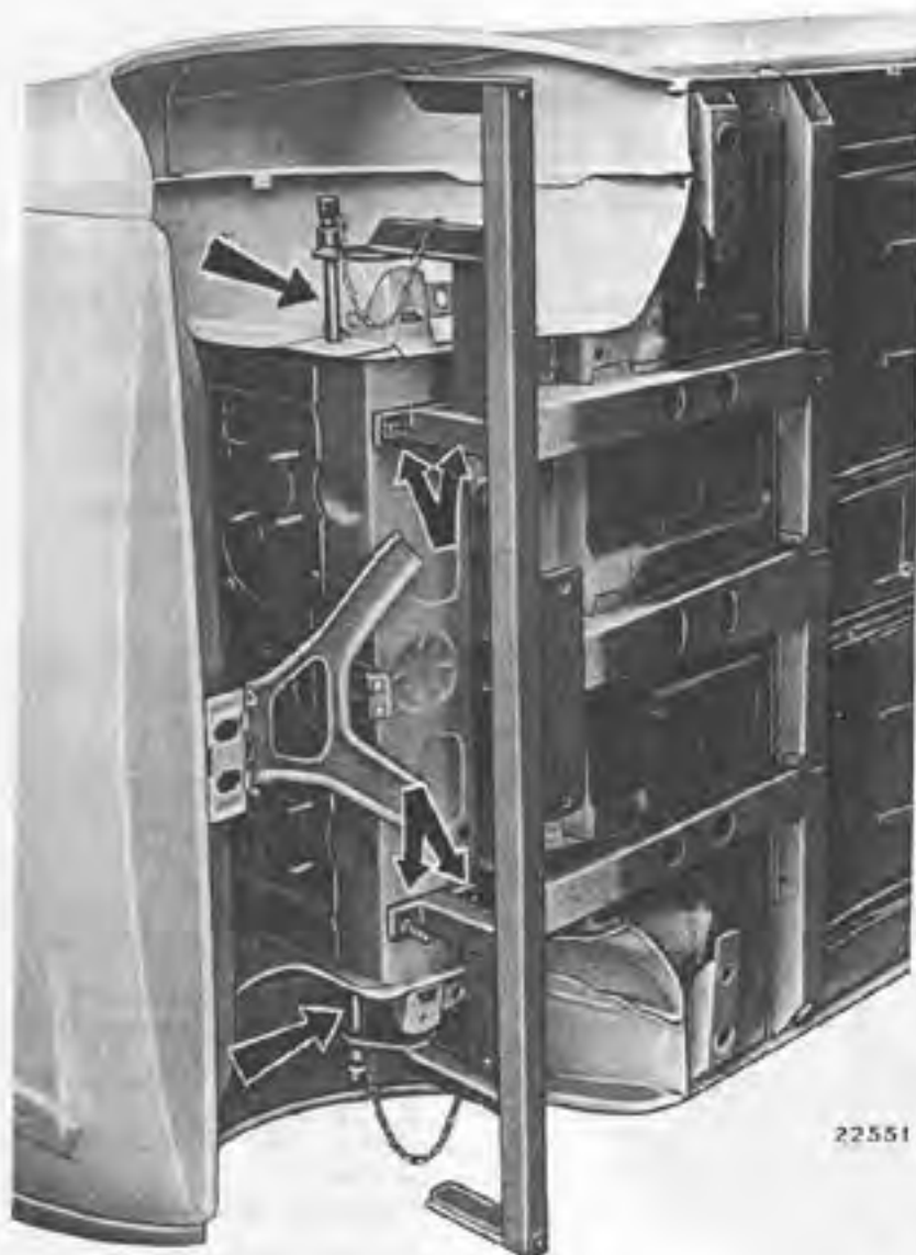
Détail du contrôle de l'avant du soubassement à l'aide de l'outil A. 78126.
