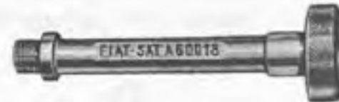
A. 60018 Bouchon de logements des bougies lors de l'essai d'étanchéité des soupapes.
