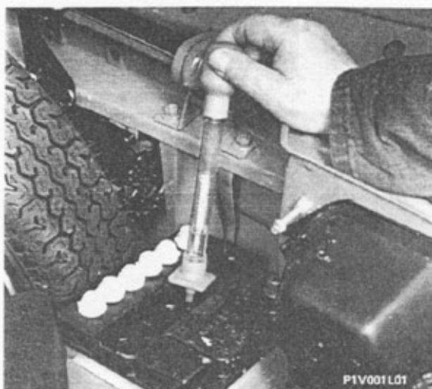
Mesure du niveau de charge de la batterie, à l'aide d'un densimètre
