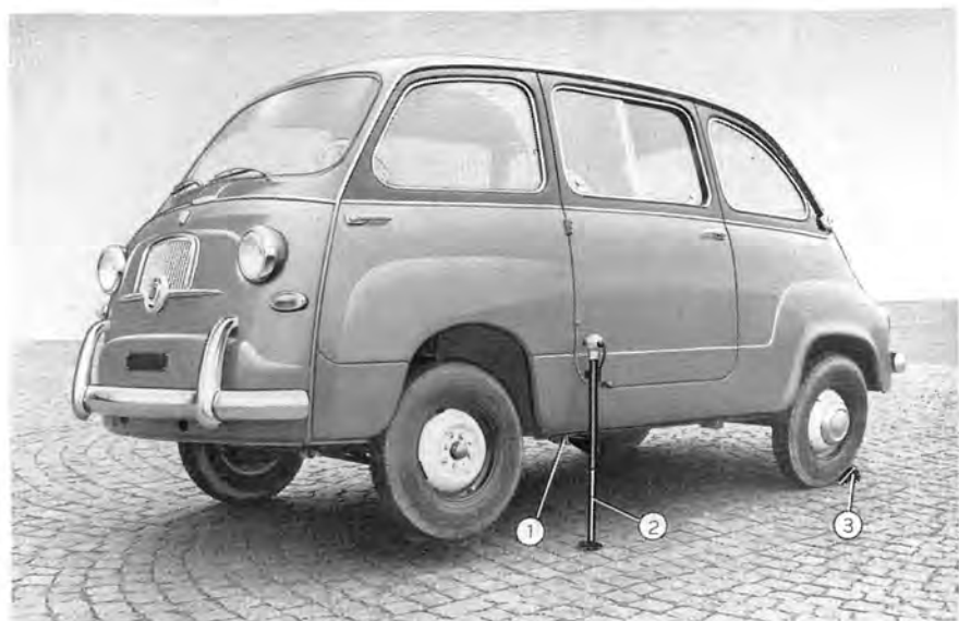
Fig. 44. - Soulèvement de la voiture au moyen du cric.
