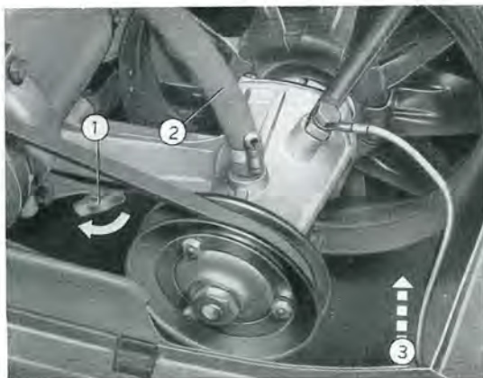
Fig. 31. - Robinets de vidange du système de refroidissement du moteur.
