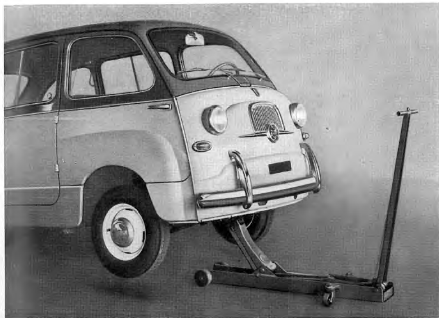
Fig. 45. - Soulèvement de la partie avant de la voiture au moyen d'un cric hydraulique à chariot.
