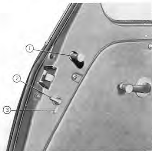
Fig. 14. - Condammation de la serrure de porte avant côté opposé à la direction.
