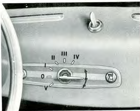
Fig. 20. - Positions de la clé dans la boîte de distribution.
