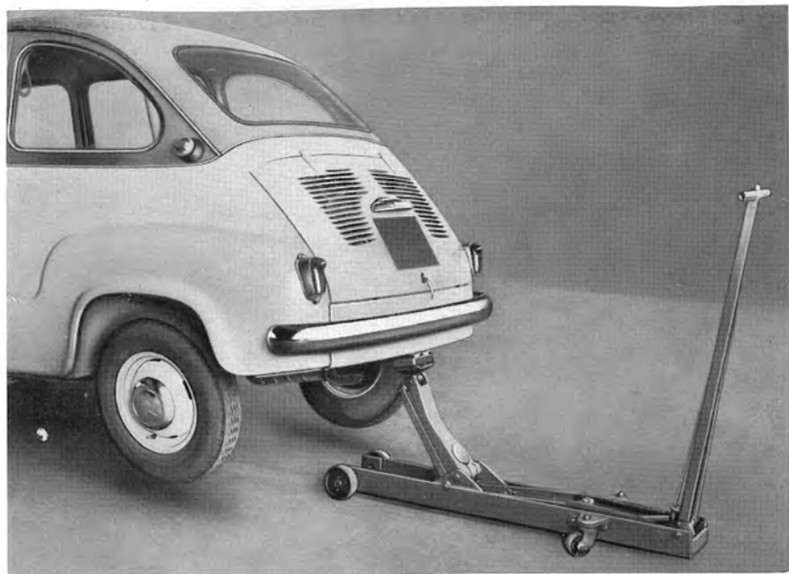
Fig. 46. Soulèvement de la partie arrière de la voiture au moyen d'un cric hydraulique à chariot.
